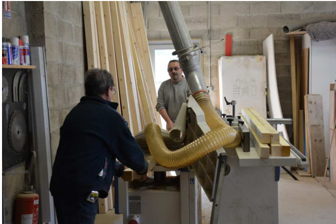
Corroyage d'un chevron brut
